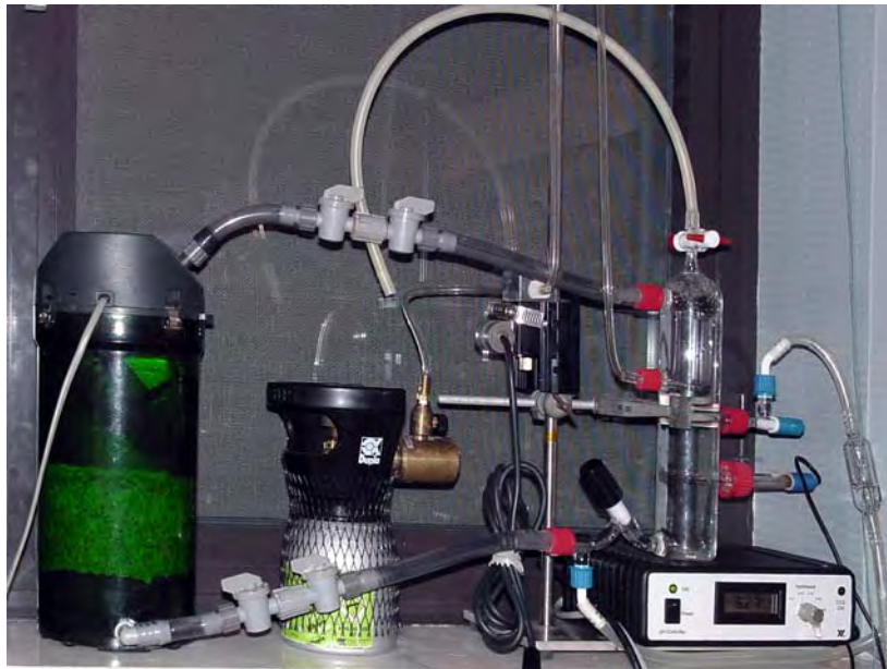
Foto 2: Om de opnamesnelheid van het calcium te bepalen werd een experimentele reactor gebouwd.
